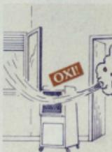
Οι συσκευές που εργάζονται με υγραερίο (γκαζέρες, θερμαστέρες κλπ) πρέπει να τοποθετούνται μακριά από καύσιμα υλικά (κουρτίνες, χαρτία κλπ) και σε σημεία με καλό αερισμό χωρίς ρεύματα αέρα.
