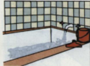
3. Θέσε σε λειτουργία τον εξεριστήρα. Γέμισε το μπάνιο με νερό, πιθανό να χρειαστεί για πυρόσβεση.
