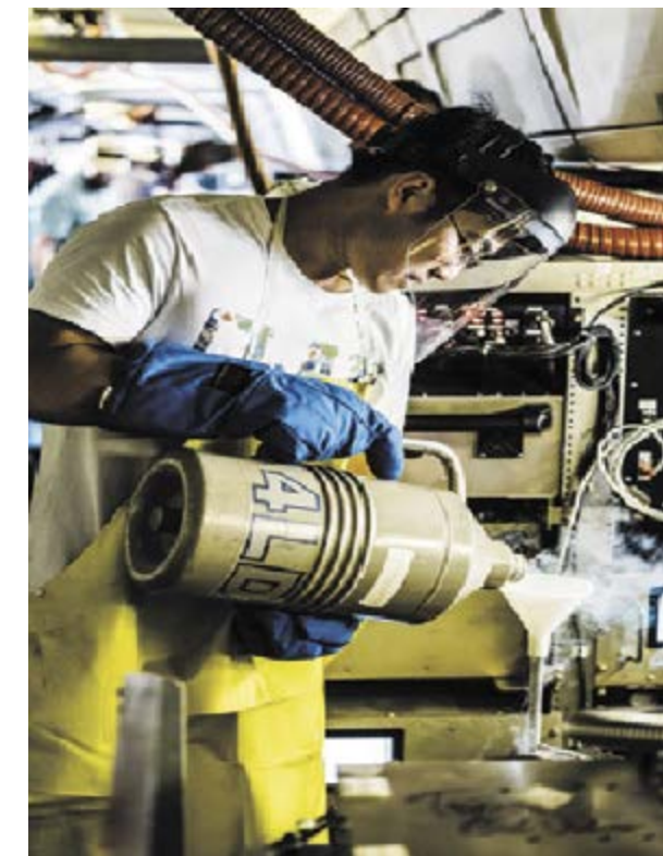
Φωτογραφία του μεταδιδακτορικού φοιτητή Xu lu τη στιγμή που προσθέτει υγρό άζωτο σε ένα μεγάλο φασματόμετρο, το οποίο χρησιμοποιείται για να μετρήσει ένα σύνολο αερίων τα οποία αφθονούν στον καπνό των πυρκαγιών βιομάζας.
