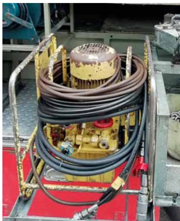
Άποψη της φορητής ηλεκτροκίνητης υδραυλικής αντλίας πίεσης για τη λειτουργία του διαστολέα ή του κόφτη
