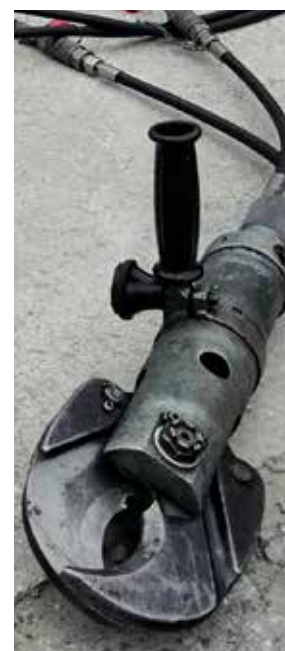
Ο κόφτης (ψαλίδι) Weber-Hydraulik με βάρος τα 14 κιλά, είχε την ικανότητα κοψίματος τους 8 τόνους και άνοιγμα λεπίδας τα 90mm
