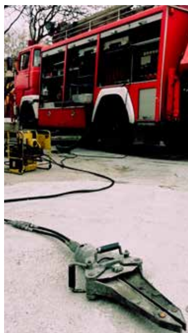
Ο «βαρύς» διαστολέας Weber-Hydraulik SP 30 του 1979 ζύγιζε 26 κιλά, είχε ικανότητα ώθησης τους 12τονους και έλξης 6,5τονους και είναι συνδεδεμένος με την ηλεκτροκίνητη φορητή αντλία πίεσης
