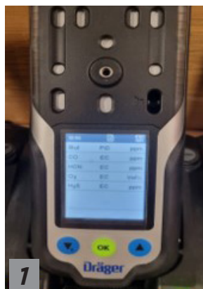
Εικόνα 1. Φορητοί Ανιχνευτές Εκρηκτικών και άλλων Αερίων για ΧΒΡΠ-Ε περιστατικά
