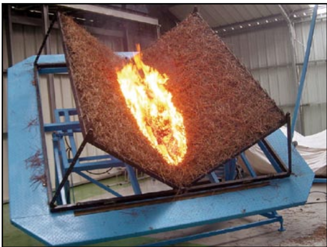
Εικ. 1: Χρήση πειραματικής τράπεζας καύσης του ADAI, για προσομοίωση πυρκαγιάς σε πλάγια με ρυθμιζόμενες συνθήκες ανέμου (αριστερά) και σε χαράδρα με ρυθμιζόμενη διατομή και κλίση.
